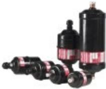
Фильтры-осушители с прямым и обратным направлением потока типа DCB предназначены для установки на жидкостные линии тепловых насосов. Фильтры-осушители типа DCB имеют встроенные обратные клапаны, которые заставляют жидкий хладагент течь от наружной стороны сердечника фильтра к центру. Тем самым частицы грязи задерживаются в фильтре независимо от направления движения потока хладагента. Фильтры-осушители DCB быстро и эффективно поглощают влагу, а также органические и неорганические кислоты.
