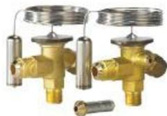
Терморегулирующие клапаны T 2 и TE 2 контролируют поступление жидкого хладагента в испарители. Расход хладагента регулируется по его перегреву на выходе из испарителя. Клапаны предназначены для подачи жидкого хладагента в «сухие» (незатопленные) испарители, перегрев на выходе из которых прямо пропорционален тепловой нагрузке на испаритель.
