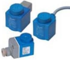
Катушки предназначены для работы в агрессивной среде с высокой влажностью и большими колебаниями температуры. Система крепления катушки с фиксатором в виде скобы позволяет легко устанавливать катушку на клапан и снимать ее. Установка катушки производится без инструментов, а ее демонтаж требует только отвертки.
