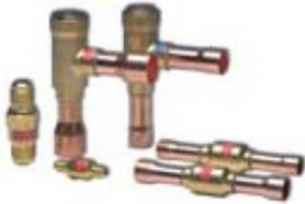
Обратные клапаны NRV и NRVH устанавливаются в жидкостных линиях, линиях всасывания и в трубопроводах горячего газа холодильных установок и систем кондиционирования воздуха, работающих на фторсодержащих хладагентах. Клапаны NRV и NRVH имеют встроенный демпфирующий поршень, позволяющий устанавливать клапан в линиях с пульсацией давления. Поставляются в исполнении со штуцерами под пайку или под отбортовку.
