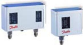
Реле давления КР предназначены для использования в холодильных установках с целью защиты системы от слишком низкого давления всасывания или слишком высокого давления нагнетания. Реле давления КР используются также для пуска и остановки компрессоров холодильных установок и вентиляторов конденсаторов, охлаждаемых воздухом. Усиленная контактная группа, рассчитанная на нагрузку 16 А, дает им возможность управлять работой электродвигателей мощностью до 2 кВт без применения контакторов.
