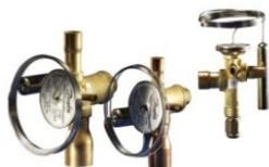
Терморегулирующие клапаны TGE контролируют поступление жидкого хладагента в испарители. Расход хладагента регулируется по его перегреву на выходе из испарителя. Клапаны предназначены для подачи жидкого хладагента в «сухие» (незатопленные) испарители, перегрев на выходе из которых прямо пропорционален тепловой нагрузке на испаритель. Наиболее часто клапаны TGE применяются в системах кондиционирования.
