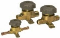
ВМ – это запорные клапаны с ручным управлением, предназначенные для установки в линии всасывания, жидкостные линии и трубопроводы горячего газа холодильных систем. Клапаны ВМ могут поставляться со штуцерами под отбортовку или под пайку ODF (с обычными или удлиненными патрубками). Модель ВМ 6 доступна как в прямоточном (BML 6), так и в трехходовом (BMT 6) исполнении.
