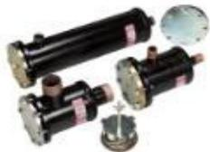
Фильтры DCR со сменным твердым сердечником (сердечниками) защищают холодильные установки и системы кондиционирования воздуха от влаги, кислот и твердых частиц. Твердый сердечник обеспечивает высокую производительность осушения и исключает образование кислот в системе. Фильтры DCR устанавливаются как на жидкостной линии, так и на линии всасывания систем охлаждения с одним или несколькими компрессорами.
