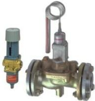
Водяные клапаны WVFX, WVO и WVS с управлением по давлению применяются для регулирования расхода воды через охлаждаемый водой конденсатор холодильной установки. Это позволяет плавно регулировать давление конденсации и поддерживать его практически постоянным во время работы холодильной установки. При остановке холодильной системы трубопровод охлаждающей воды перекрывается автоматически.
