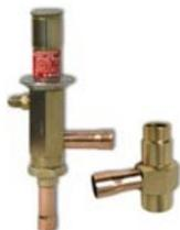
Регуляторы производительности CPCE применяются для согласования производительности компрессора с фактической нагрузкой на испаритель. Регуляторы CPCE устанавливаются в байпасную линию между сторонами низкого и высокого давления системы охлаждения и осуществляют перепуск горячего газа в участок холодильного контура между испарителем и терморегулирующим клапаном.
