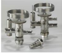
Терморегулирующие клапаны TUA/TUAE контролируют поступление жидкого хладагента в испарители. Расход хладагента регулируется по его перегреву на выходе из испарителя. Клапаны предназначены для подачи жидкого хладагента в «сухие» (незатопленные) испарители, перегрев на выходе из которых прямо пропорционален тепловой нагрузке на испаритель.
