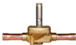
Электромагнитные клапаны предназначены для установки в жидкостные и всасывающие линии, а также трубопроводы горячего газа. Клапаны подходят для любых применений, например системах холодоснабжения, шоковой заморозки, охлаждения жидкости и систем кондиционирования, работающих на фторсодержащих хладагентах. При отсутствии питания на электромагнитной катушке клапан остается открытым.
